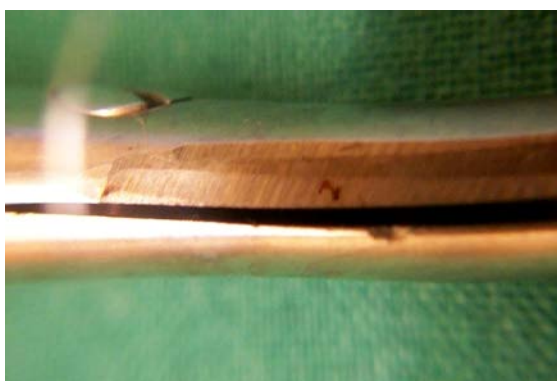
Mehrere Winkel auf der Schneidekante
