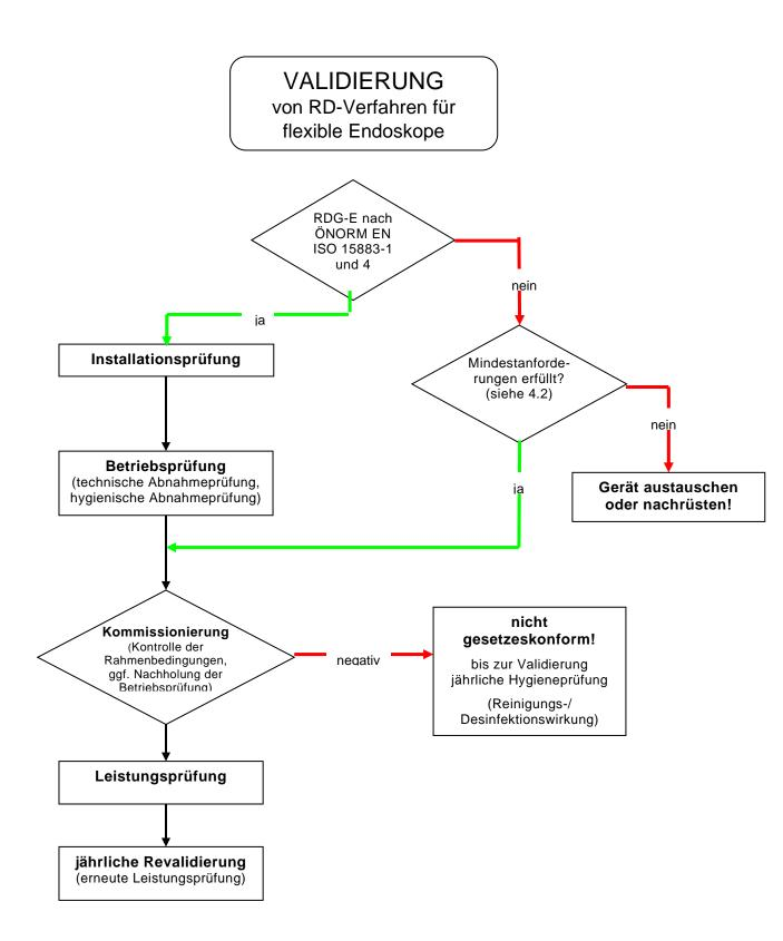
Abb. 1: Flussdiagramm zum Ablauf der Validierung
