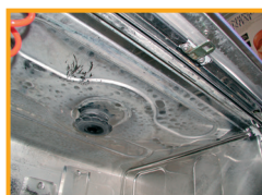
Spülkammer mit starkem Kalkbefall
