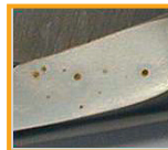
Schere mit Lochkorrosion
