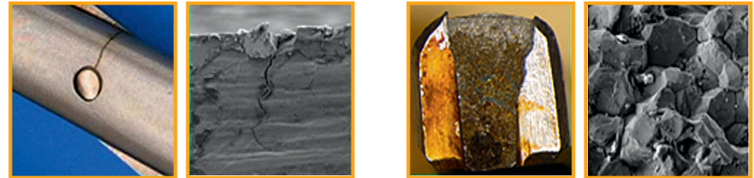
Detail: Schlussgelenk Schere mit typischem interkristallinem Anriss.
