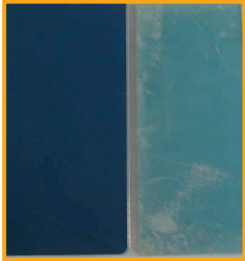
Links: Original Rechts: Optische Veränderung bei farbeloxiertem Aluminium
