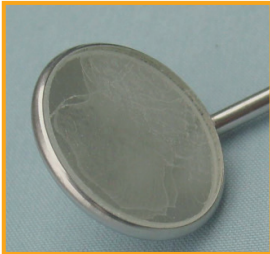
Verfleckungen auf Grund hohen Salzgehalts im Abspülwasser
