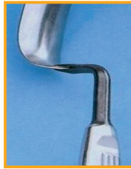
Wundhaken mit schwarz verfarbtem Schaft aus gehärtetem Cr-Stahl und blank gebliebenen Griff und Blatt aus nicht härtbarem CrNi-Stahl
