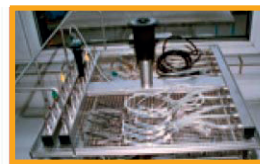
Falsche Beladung eines Reinigungs- und Desinfektionsgerätes
