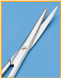
Schere mit abgebrochener Spitze. Ursache: unsachgemäßes Ablegen
