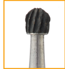
Korrodiertes, verschlissenes Hartmetallbohrkopf aus WC/CO. Ursache: Anwendung eines sauren Reinigers.
