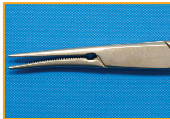
Verformung durch unsachgemäße Handhabung
