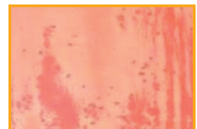
Starker Materialangriff natur- und farbeloxierter Aluminiumoberflächen bei einem Instrumentenständer und Containern. Ursache: Überdosierung der sonst materialverträglichen alkalischen Waschlösung.
