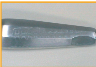
Verschleppung von Reinigungsmittelrückständen durch unzureichende Spülung
