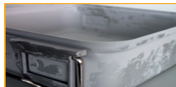
Starker Materialangriff natur- und farbeloxierter Aluminiumoberflächen bei einem Instrumentenständer und Containern. Ursache: Überdosierung der sonst materialverträglichen alkalischen Waschlösung.
