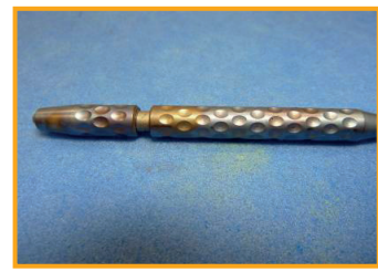
Verfarbter Instrumentengriff aus Titanwerkstoff
