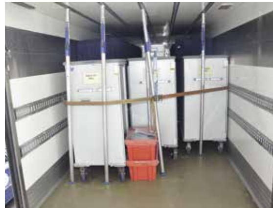
Foto Nr. 2 Befestigungssystem im Laderaum des Lastwagens (Ref. Tiziano Balmelli).
